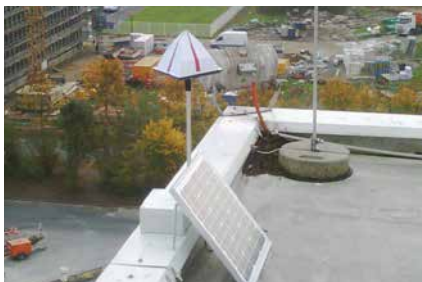
Solarbetriebenes Eagle Eye®. Keine Strominstallation erforderlich
